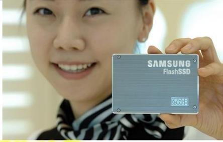
Una unidad de estado sólido o SSD (acrónimo de solid-state drive) es un dispositivo de almacenamiento de datos que usa una memoria "flash" no volátil (no es un disco).
